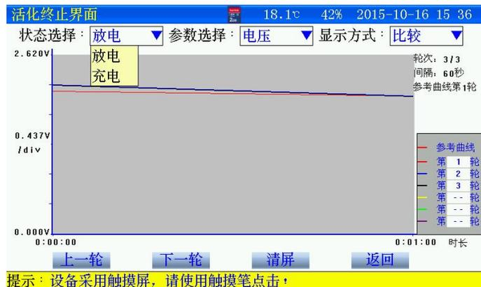
图 3.5.4-1 放电电压比较方式曲线界面
