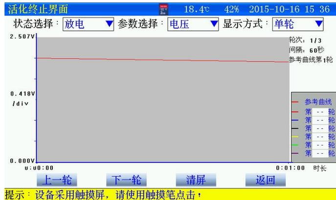
图 3.5.4 单次放电电压曲线界面
