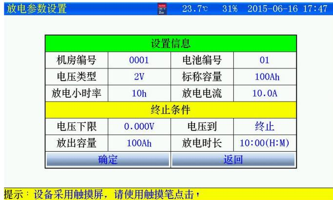
图 3.1.2 放电参数设置界面
